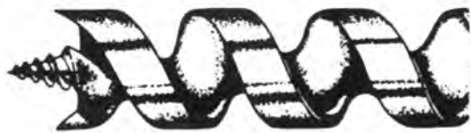
شکل ۱۲-۲۱. سر مته‌ی مدل دو گلاس.
