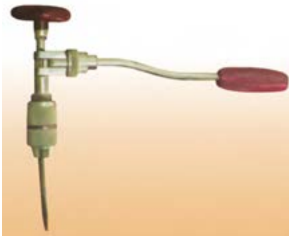
شکل ۱۲-۲. دریل شتر گلو، مفصوم گوشه کار.
