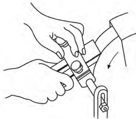
شکل ۱۴-۲۴- تیزکردن تیغه رنده با سنگ سنباده.
