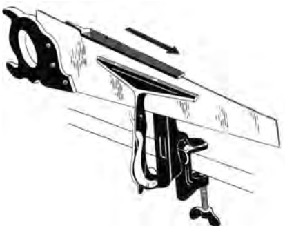
شکل ۱۴-۶۲- میزان کردن دندان‌های اره به وسیله سوهان.
