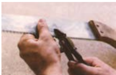
شکل ۱۴-۵۴-۱. فم کردن بقیه دندانها به طرف پایین.
