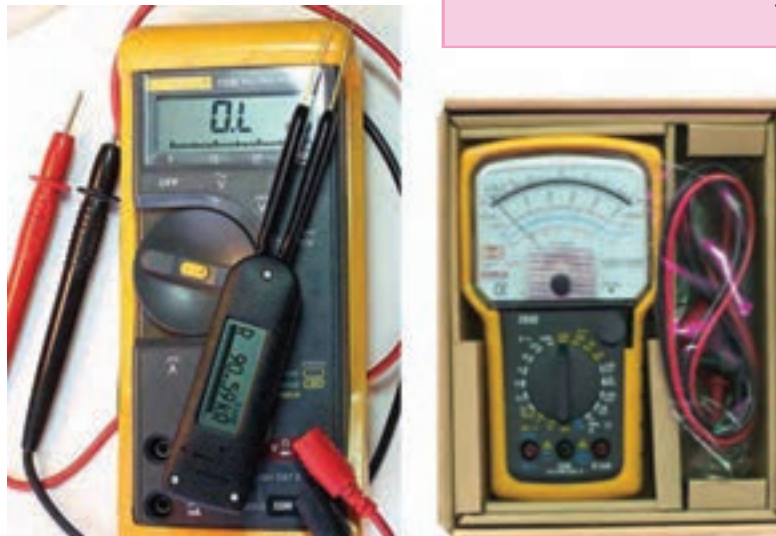
شکل ۴۱-۱- مولتی متر آنالوگ و دیجیتال
