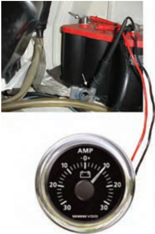
شکل ۱-۵۲ اتصال آمپر متر به صورت سری
