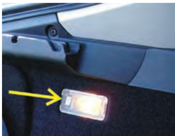
شکل ۲۱۸-۱- چراغ صندوق عقب و سوئیچ روی آن
