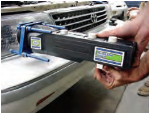
شکل ۱-۱۶۴- نصب هدف گیر به روی بلوری چراغ بزرگ جلو
