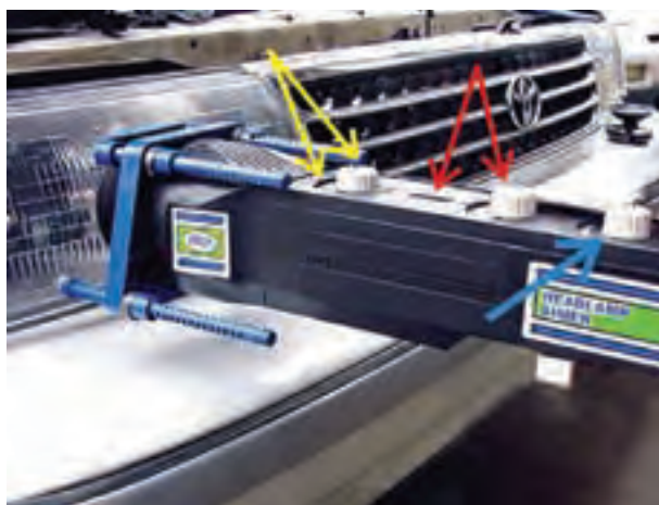
شکل ۱۶۱-۱- پیچ‌های تنظیم دستگاه تنظیم نور چراغ‌ها
