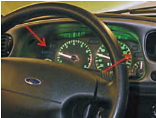
شکل ۱-۲۰۱- محل چراغ‌های اخطار روی صفحه‌ی نشان‌دهنده‌های یک نوع خودرو
