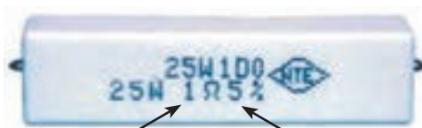
تولرانس 5 درصد مقدار مقاومت یک اهم
