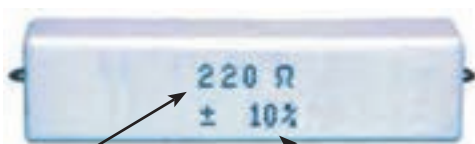
تولرانس ده درصد مقدار مقاومت 220 اهم
