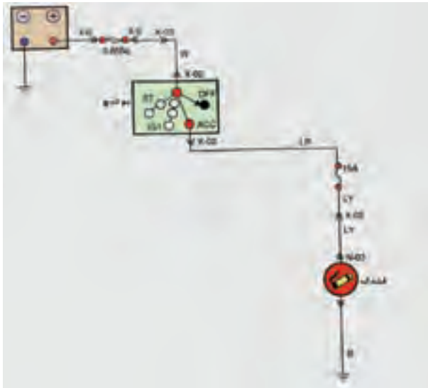
شکل ۱-۲۲۹ نمودار مدار الکتریکی فندک
