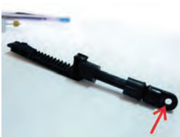
شکل ۱۸-۲- شانه‌ی دندانه‌دار دو قسمتی (محور عملگر)
