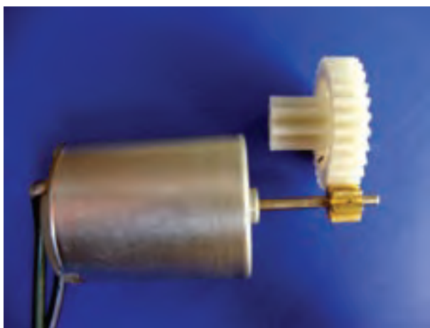
شکل ۱۹-۲- چرخ‌دنده‌ی واسطه عملگر و نحوه‌ی ارتباط و درگیری آن با چرخ‌دنده‌ی محور موتور الکتریکی
