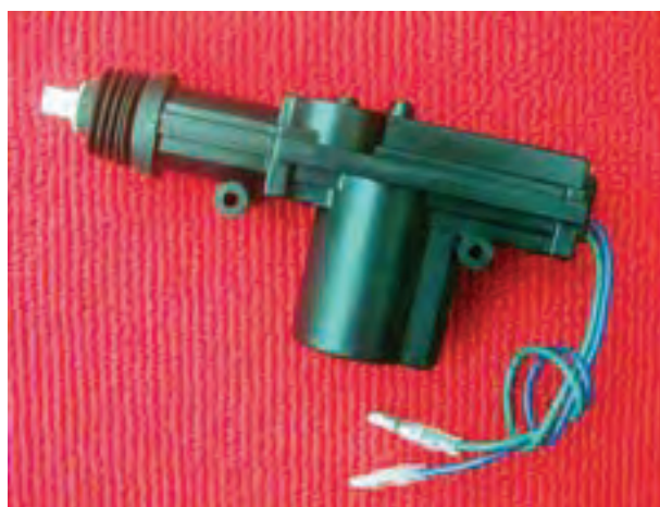
شکل ۲-۸- یک نوع عملگر سیستم قفل مرکزی
