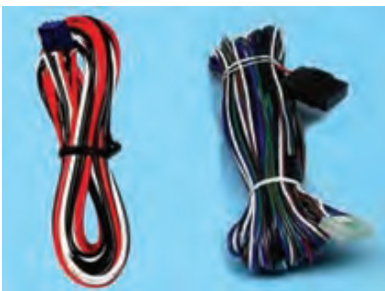
شکل ۱۴-۲- دسته‌ی سیم‌های مدار قفل مرکزی
