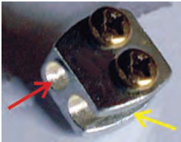
شکل ۲-۱۵- بست مورد استفاده در سیستم قفل مرکزی
