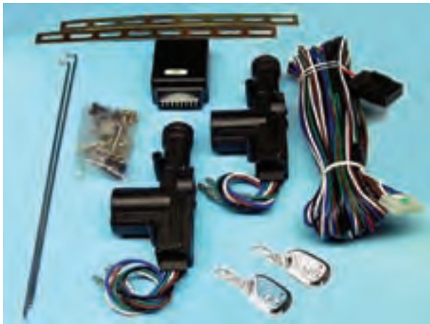
شکل ۱-۲- اجزای مدار قفل مرکزی
