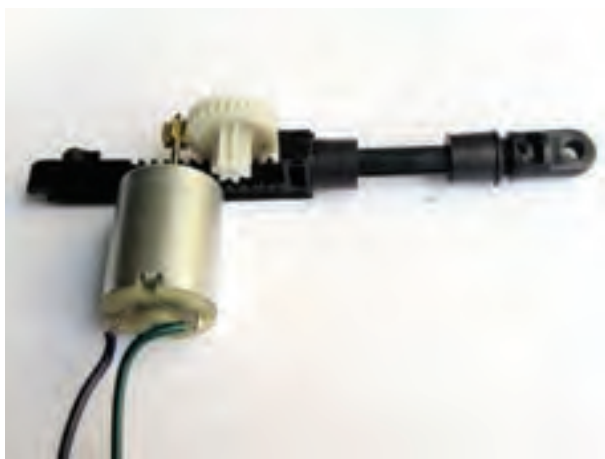
شکل ۲۰-۲- نحوه‌ی ارتباط چرخ‌دنده‌ها هنگام تبدیل دور
