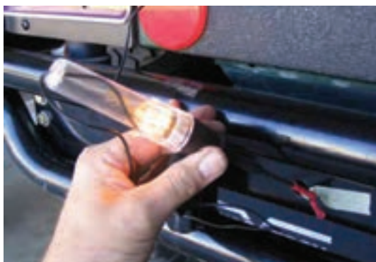
شکل ۸۶-۲- استفاده از تستر لامپی
