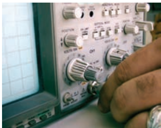
شکل ۱۱۴-۲ نحوه‌ی اتصال BNC به اسیلوسکوپ
