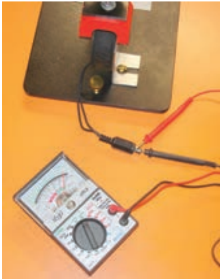
شکل ۸۴-۲-ج - آزمایش به وسیله‌ی اهم متر عقربه‌ای
