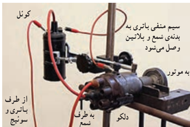
شکل ۲-۱۴۴- مدار شبیه‌سازی شده‌ی سیستم جرقه‌زنی
