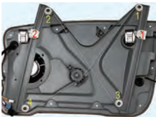
شکل ۱۰۶-۲- نحوه‌ی ارتباط رگلاتورهای مکانیزم شیشه بالابر
