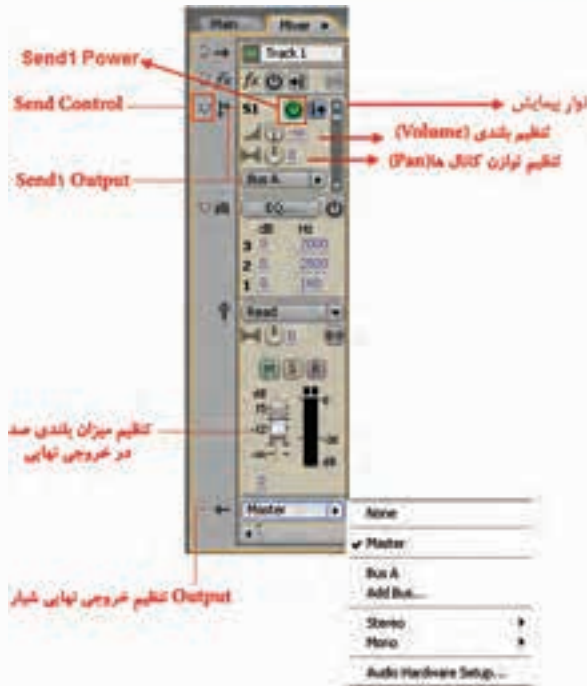
شکل ۱۴-۱۰ کنترل‌های مسیریابی شیار
