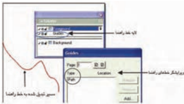
شکل ۲-۱۲ مسیر تبدیل شده به خط راهنما با استفاده از لایه Guides
