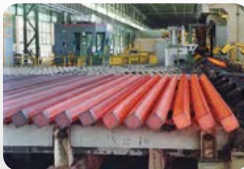
آهن در دمای بالا گداخته می‌شود
