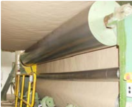
غلنگ آهنی برای صاف کردن خمیر کاغذ
