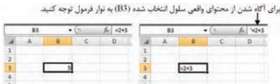
شکل ۲-۶ عبارت به صورت فرمول (سمت چپ) و به صورت داده (سمت راست)
