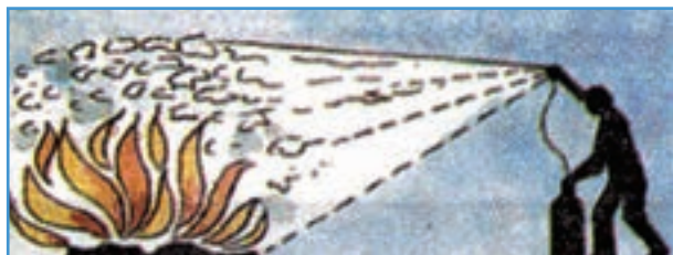
شکل ۱۵-۱- خاموش کردن آتش با کف
