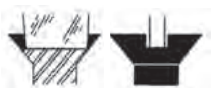
شکل ۷۱-۳- طرز قرار گرفتن لبه پیچ گوشتی در شیار پیچ
