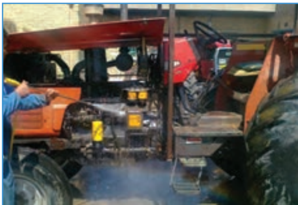
شکل ۵-۱- شستشوی موتور تراکتور
