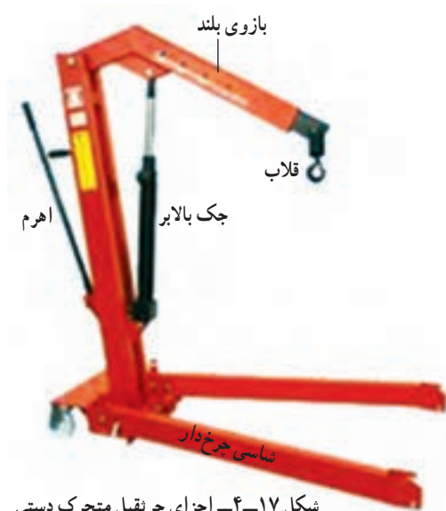
شکل ۱۷-۴ اجزای جرثقیل متحرک دستی
