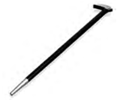
شکل ۷۲-۳- اهرم مخصوص خارج کردن انزکتور
