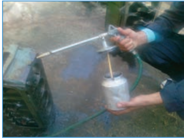
شکل ۱-۳- باز کردن مخزن پیستوله شستشو
