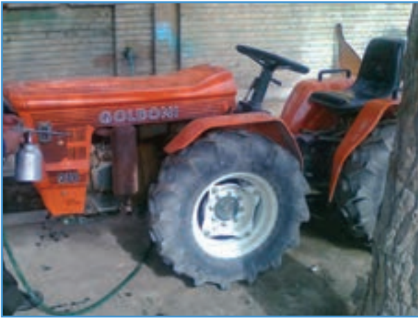
شکل ۱-۴- شستشوی موتور تراکتور با پیستوله شستشو
