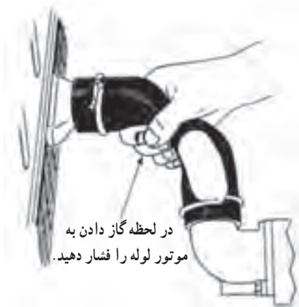
شکل ۲۰-۳- نحوه فشار دادن شیلنگ بالای رادیاتور
