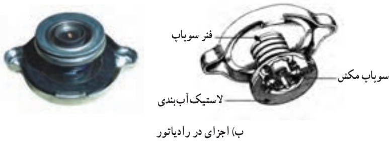
شکل ۳-۵- در رادیاتور و طرز کار سوآپ‌های آن
