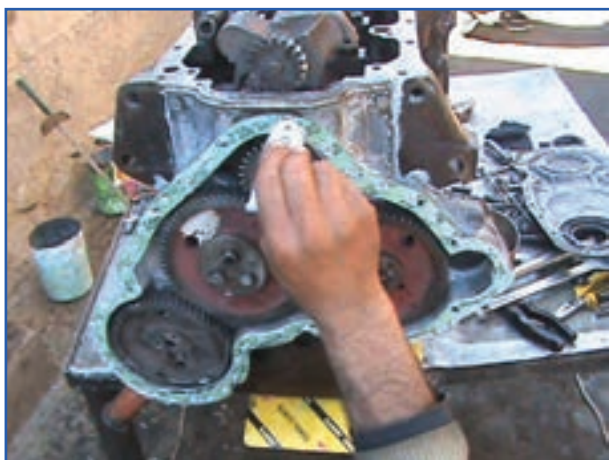
شکل ۴۴-۷- چسب زدن به محل نصب سینی جلو
