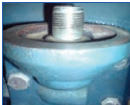
شکل ۱۷-۷- پایه صافی روغن تراکتور U650M
