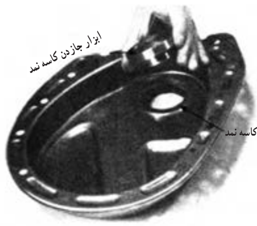
شکل ۴۳-۷- نحوه جازدن کاسه نمد روی سینی جلو
