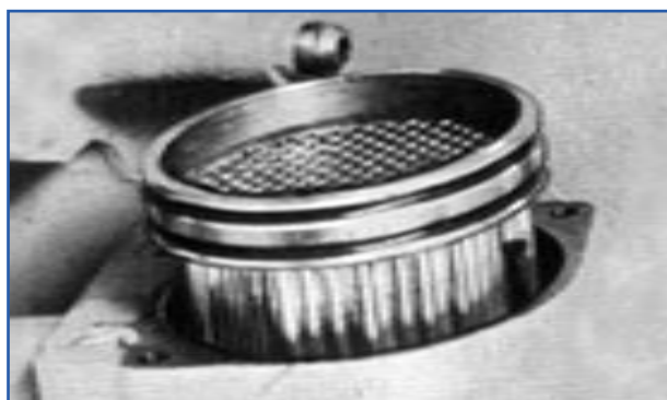
شکل ۳۵-۷- محل قرار گرفتن کویل روغن
