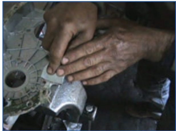
شکل ۴۱-۷- تمیز کردن واشر سینی جلو با کاردک
