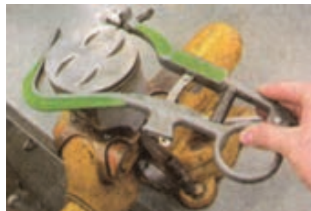
(ب) کاربرد ابزار تمیزکننده شیار رینگ‌ها
