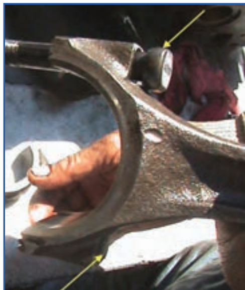
شکل ۸۵-۴- خارج کردن پیچ شاتون
