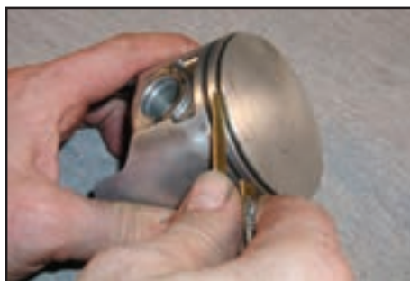
(د) تمیز کردن شیار با ابزار برنجی
