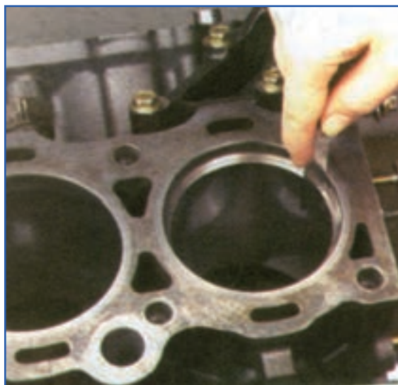
شکل ۱۲۸-۴- طرز اندازه‌گیری دهانه رینگ با فیلر
