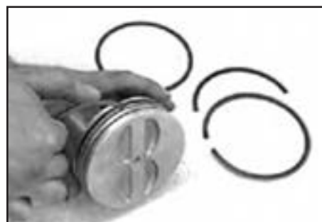
(ج) تمیز کردن شیار رینگ‌ها با رینگ شکسته
