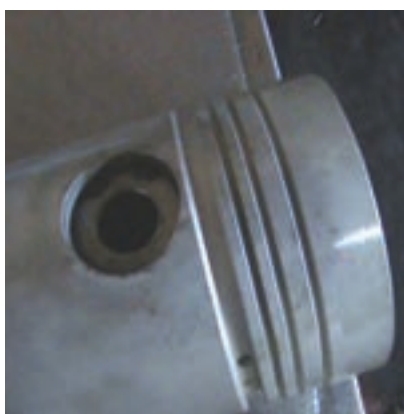
شکل ۱۲۳-۴ میزان داخل شدن انگشتی در پیستون
