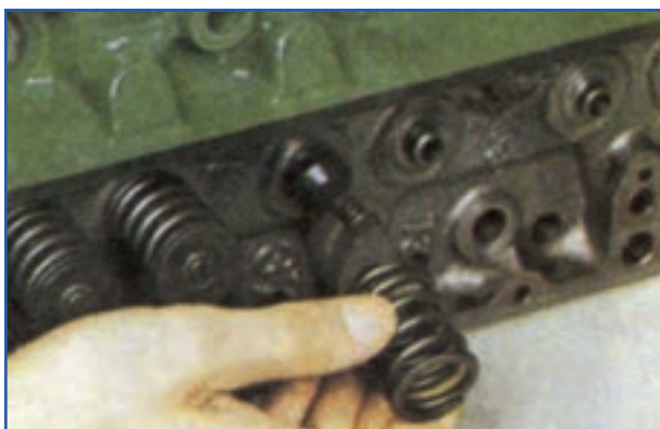
شکل ۴-۲۱- نحوه برداشتن فنر سوپاپ
