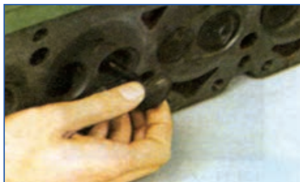
شکل ۲۳-۴- نحوه خارج کردن سوپاپ‌ها
