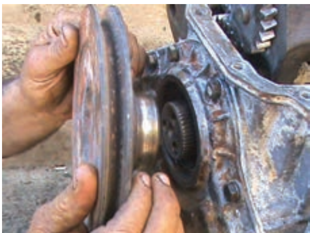
شکل ۴-۵۷- خارج کردن پولی میل لنگ
