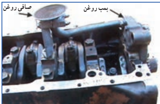
الف) محفظه میل‌لنگ بدون کارتر
