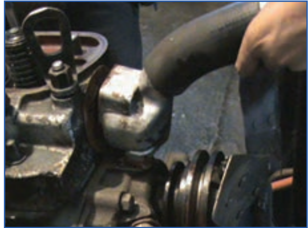
الف) باز کردن محافظه ترموستات تراکتور u650
