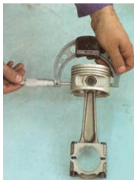
(الف) اندازه‌گیری قطر دامن پیستون
