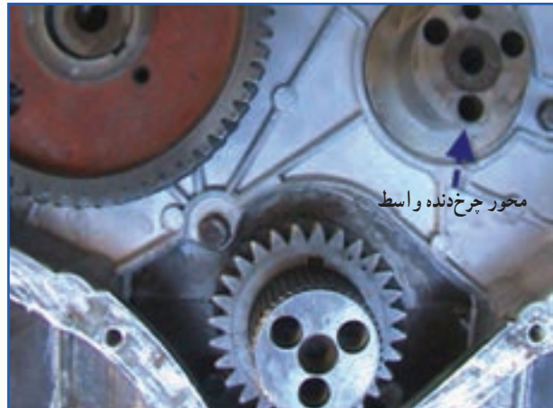
شکل ۶۷-۴ چرخ‌دنده واسط برداشته شده است.
