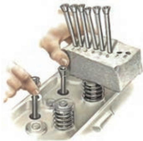
ب) به ترتیب قرار دادن میل تایپت
