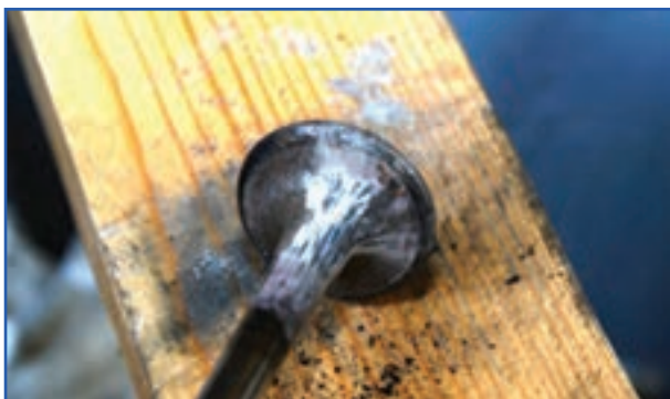
(ب) سوپاپ تمیز شده با کاردک
