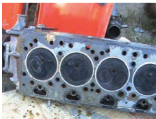
شکل ۱۵-۴- طرز قرار دادن سرسیلندر روی سطح صاف
