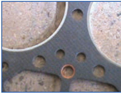
ب) سمت باریک نوار فلزی واشر سرسیلندر
