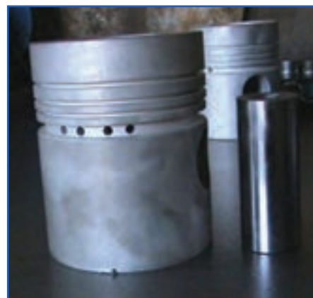
شکل ۱۰۷-۴- پیستون و انگشتی نو
