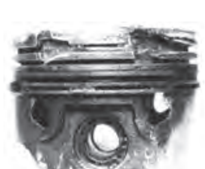
شکل ۱۰۰-۴- تخریب شدید جای رینگ
