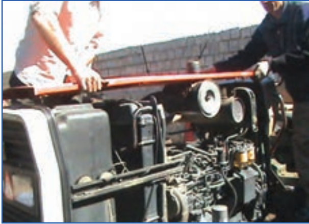
شکل ۱-۴- برداشتن کاپوت از روی موتور
