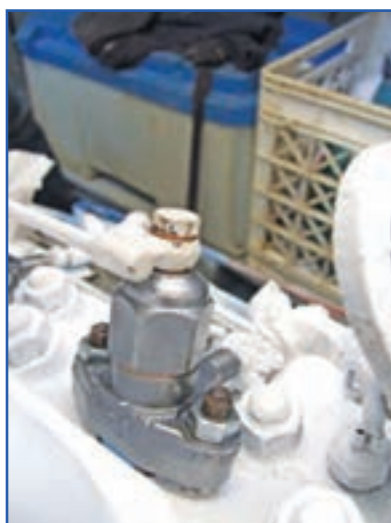
شکل ۵۴-۴- مراحل بستن انژکتور
