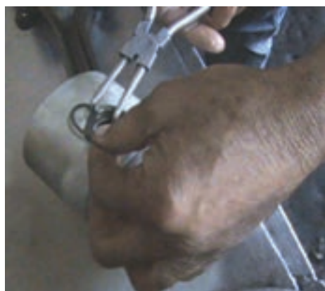
شکل ۱۲۵-۴ طرز جازدن خار انگشتی
