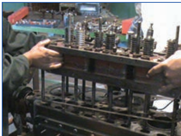
شکل ۱۴-۴- بلند کردن سرسیلندر از روی بدنه سیلندر
