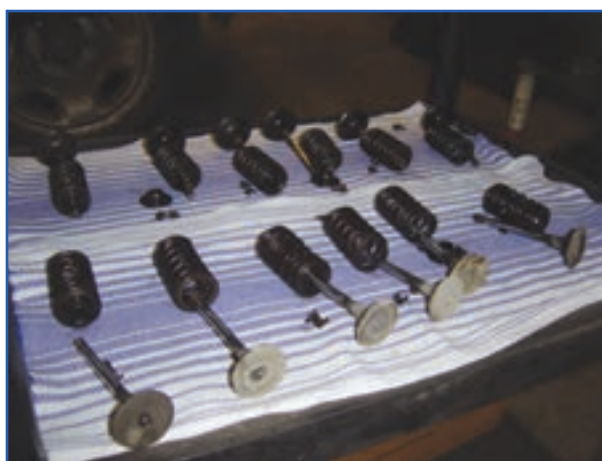
الف) اجزای باز شده سوپاپ
