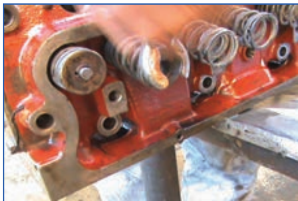
شکل ۴-۱۹- باز کردن اهرم فنر جمع کن
