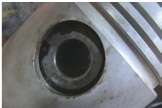
شکل ۱۲۵-۴- جا افتادن خار انگشتی در شیار پیستون
