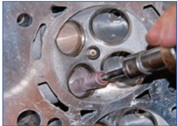
الف) نحوه تمیز کردن محفظه پشت سوپاپ
