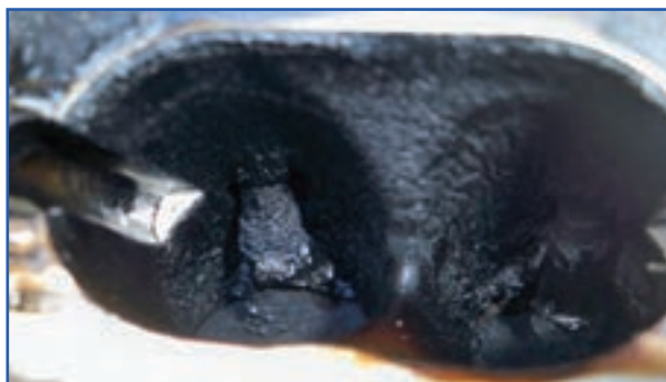
الف) کربن محفظه پشت سوپاپ‌ها
