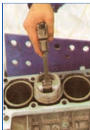
شکل ۱۲۷-۴- طرز قرار دادن رینگ داخل سیلندر
