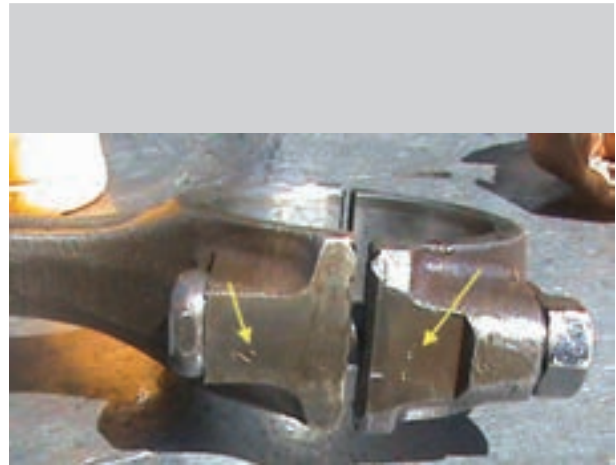
شکل ۸۷-۴- علامت روی کپه شاتون و شاتون
