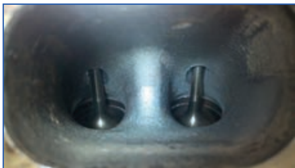
ب) محفظه تمیز پشت سوپاپ‌ها
