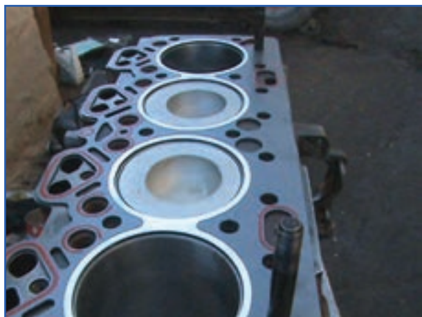
شکل ۵۲-۴- قرار دادن واشر سرسیلندر روی بدنه سیلندر
