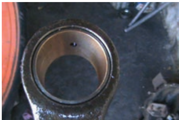
شکل ۱۲۰-۴ قرار گرفتن سوراخ بوش مقابل سوراخ شاتون
