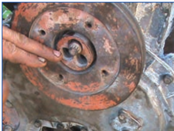
شکل ۴-۵۵- بستن پیچ سر میل لنگ تراکتور
