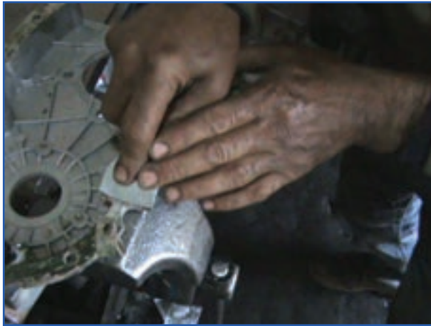
شکل ۷۶-۴- تمیز کردن واشر محفظه جلو موتور
