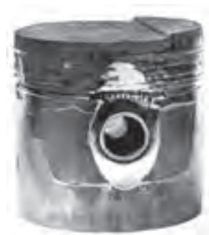
شکل ۱۰۳-۴- سایش غیریکنواخت پیستون
