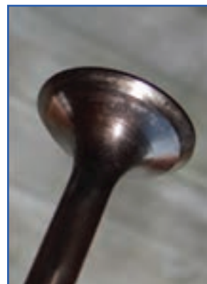
شکل ۴۵-۴- کربن گرفتن بشقابک سوپاپ
