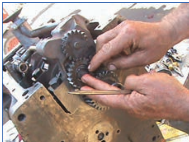
شکل ۷۹-۴- خارج کردن چرخ‌دنده بلمپ روغن
