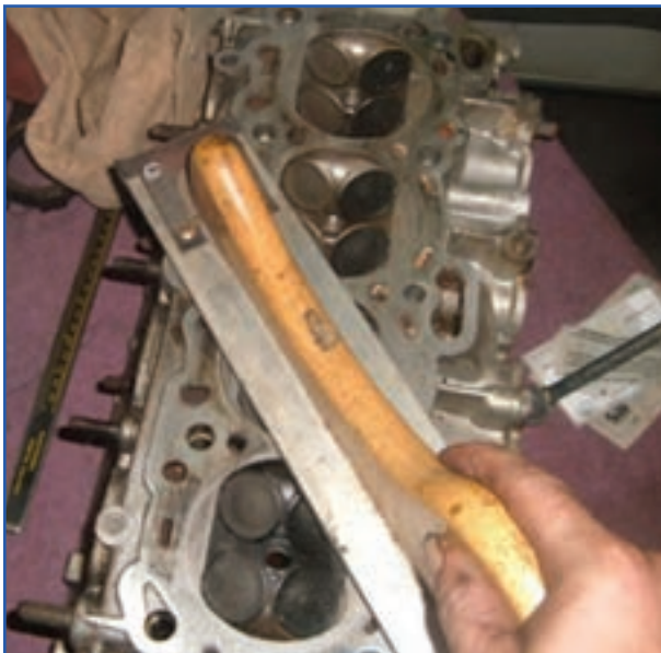
شکل ۴۴-۴- تمیز کردن سرسیلندر با سوهان نرم
