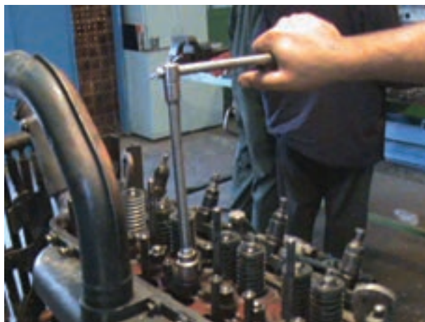
الف) باز کردن پیچ‌های سرسیلندر تراکتور U650
