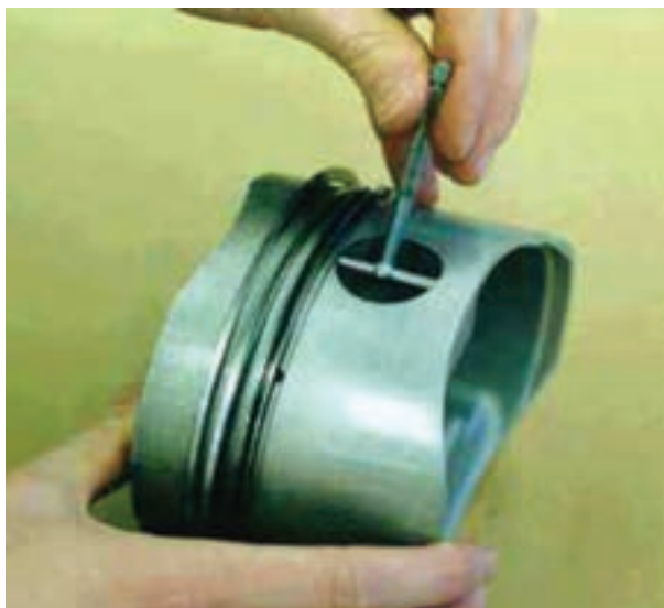
شکل ۱۱۷-۴- اندازه‌گیری سوراخ انگشتی روی پیستون
