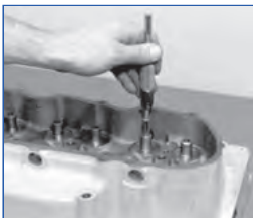
شکل ۴۰-۴- تمیز کردن گیت سوپاپ
