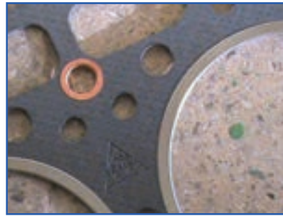
الف) سمت پهن نوار فلزی واشر سرسیلندر
