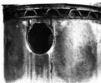
شکل ۱۱۹-۴- خراب شدن جای خار انگشتی
