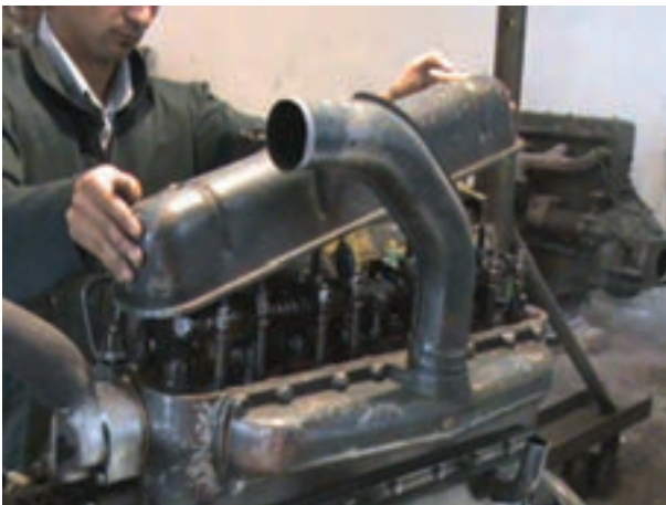
شکل ۴-۷- برداشتن درپوش سوپاپ
