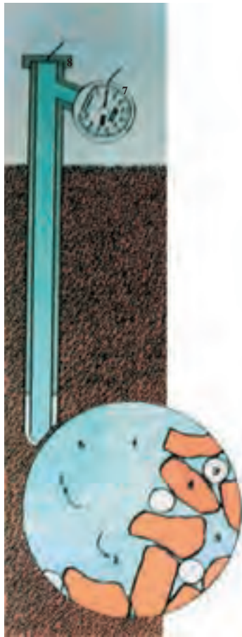
شکل ۱۸-۱- تانسومتر و نحوه قرار گرفتن آن در خاک
