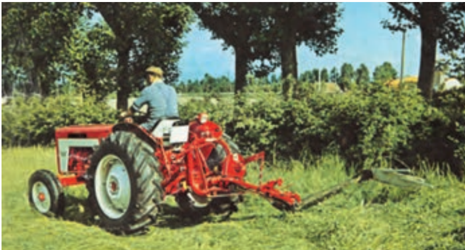
شکل ۱۳-۱- دروگر شانه ای در حین کار
