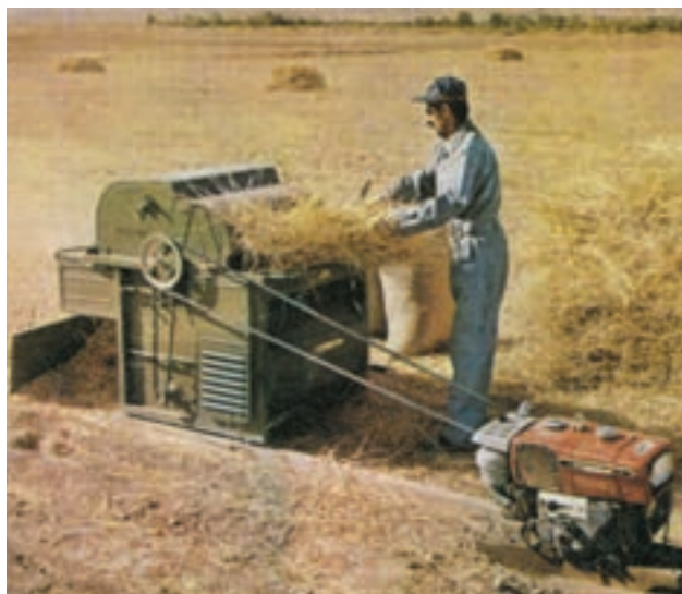
شکل ۱-۲۳- خرمنکوب با موتور تیلر در حال کار
