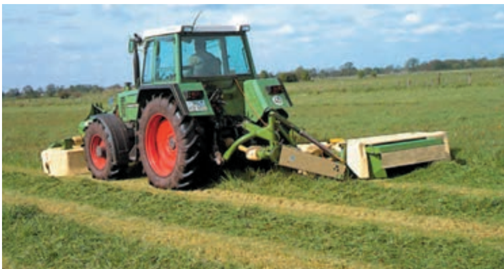
شکل ۱۵-۱- دروگر دوار در حال کار
