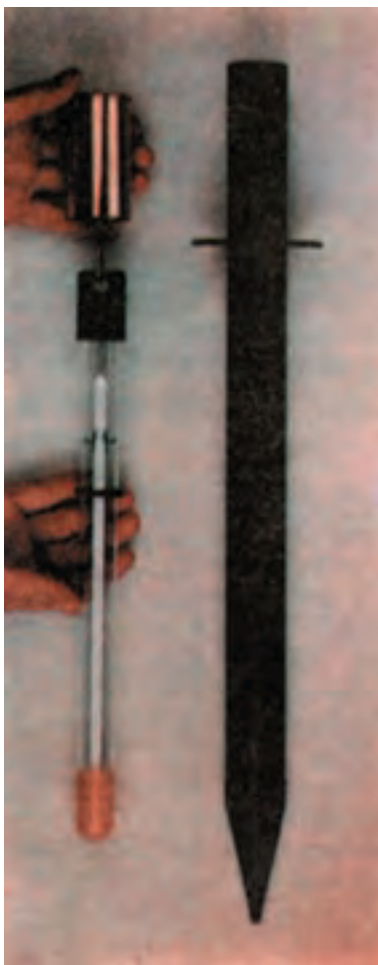
شکل ۲-۲- دماسنج برای اندازه‌گیری درجه حرارت خاک
