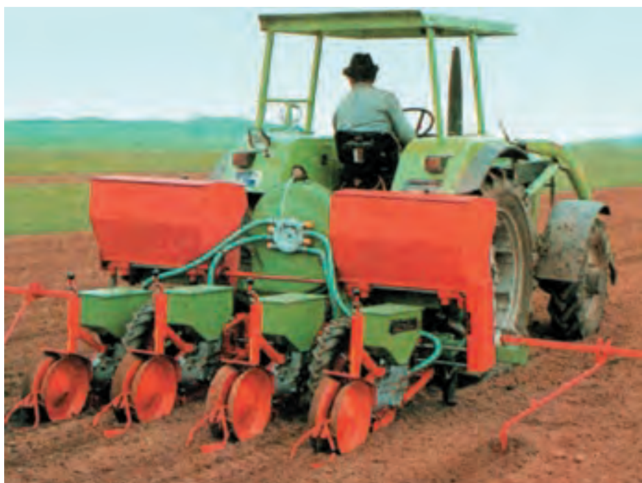
شکل ۲-۴- یک ردیفکار پنوماتیکی حین انجام کار
