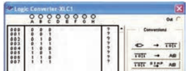
شکل ۲-۲۵ تنظیم جدول صحت روی دستگاه مبدل منطقی
