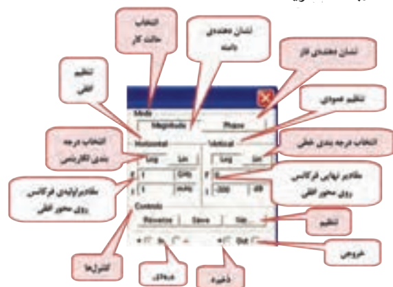
شکل ۴-۵ تنظیمهای دستگاه Bode Plotter
