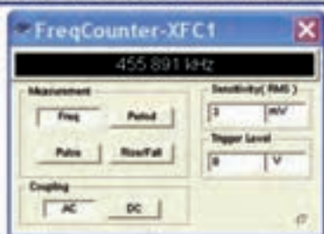
شکل ۵-۱۶ مقدار فرکانس و شکل موج خروجی مدار میکسر
