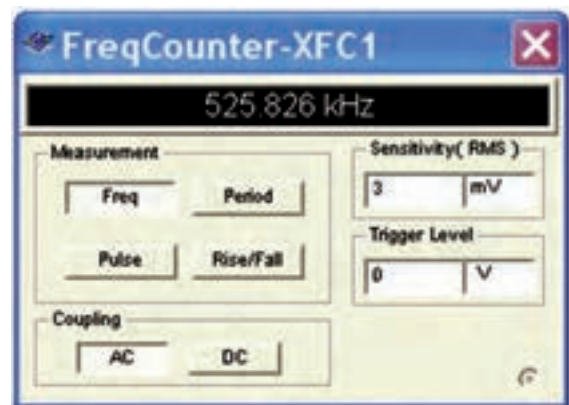
شکل ۱۱-۵ فرکانس خروجی مدار مدولاتور ترانزیستوری
