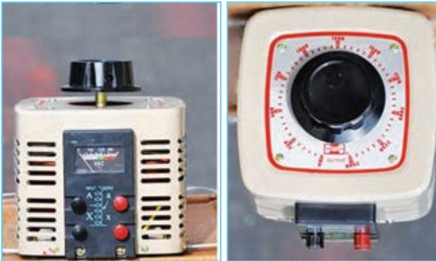
شکل ۶۶- نمای ظاهری و شماتیک اتوترانسفورمر متغیر (اریاک)
