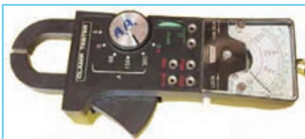
شکل ۵۸ - نمای ظاهری یک آمپر متر انبری
