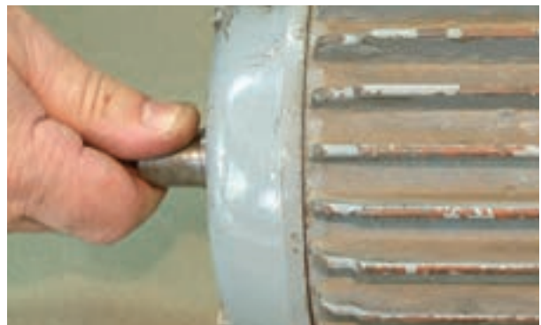
شکل ۳۰-۶ - آزمایش لنگی (لقی) بوش‌ها یا بلبرینگ‌ها
