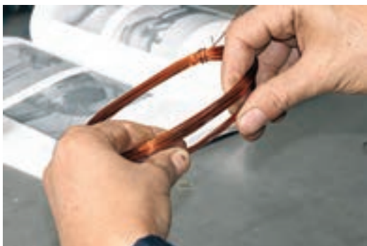
شکل ۱۶-۶- مرتب کردن سیم‌ها جهت کلاف گذاری
