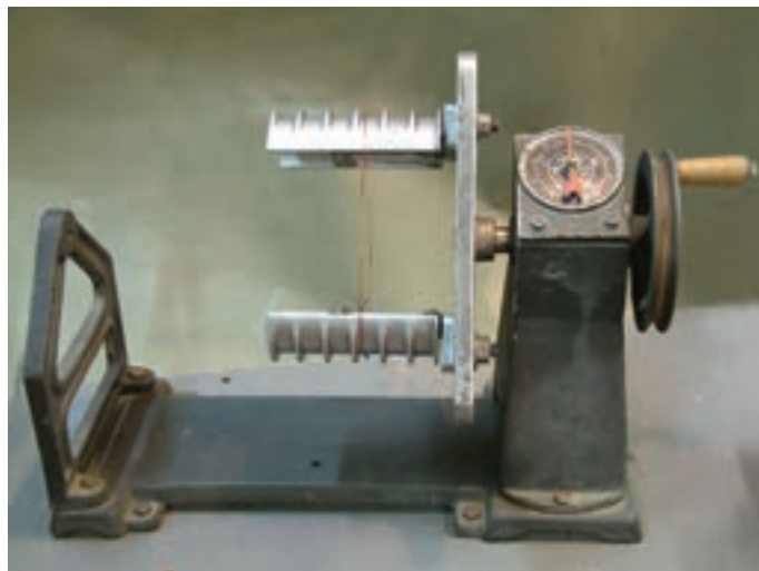
شکل ۹-۶- طریقه‌ی اندازه‌کردن بوبین در کلاف پیچ
