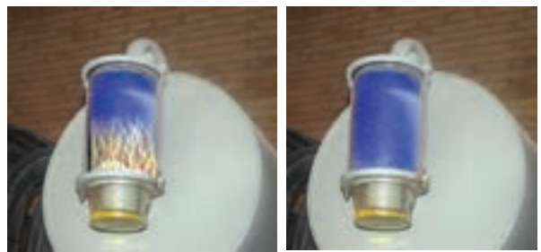
شکل ۲۶- رنگ ماده رطوبت گیر قبل و بعد از جذب رطوبت
