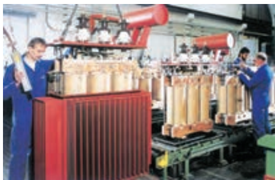
شکل ۱۵- نحوه قرار دادن هسته و سیم پیچ ها در داخل مخزن روغن
