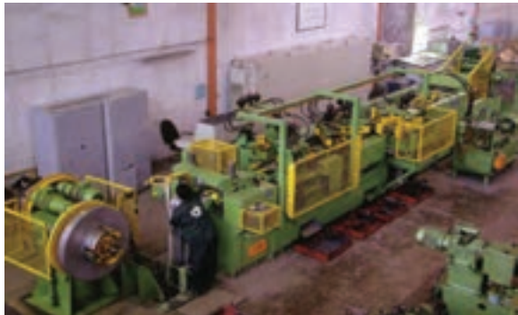
شکل ۱۲- قرقره ورق مغناطیسی در خط تولید ورق هسته
