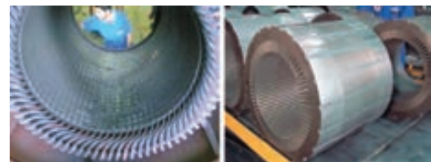
شکل ۳- هسته استاتور، بدنه و سیم پیچ استاتور
