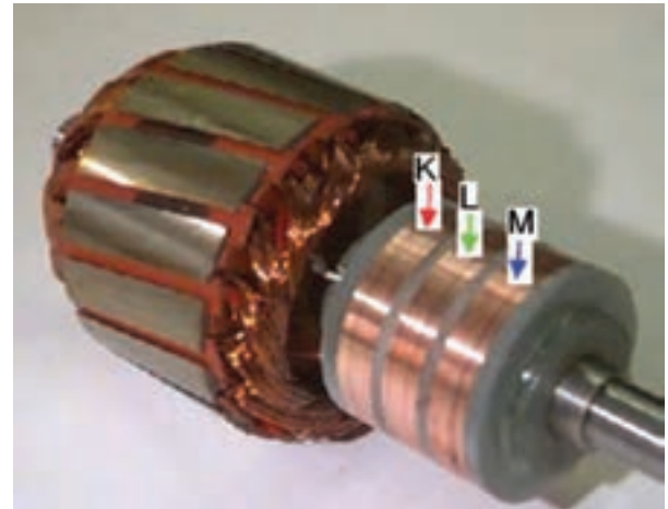
شکل ۸- رتور سیم پیچی شده در ابعاد مختلف
