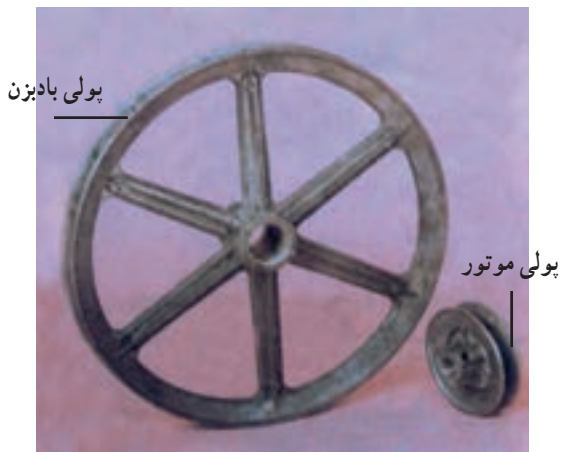
شکل ۸-۱۱ - پولی‌های موتور و فن
