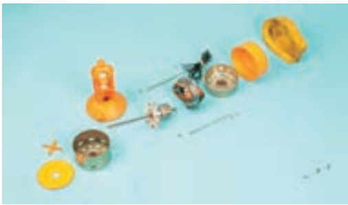
شکل ۱۸-۸ - نمایش ظاهری و اجزای یک واترپمپ
