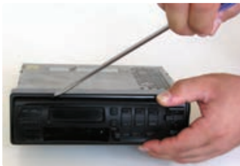
شکل ۲-۳۱- نحوه خارج کردن نادرست قاب
