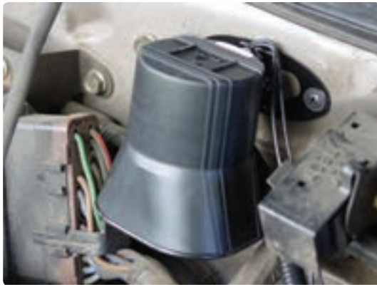
شکل ۲-۳- یک نوع آژیر سیستم دزدگیر خودرو
