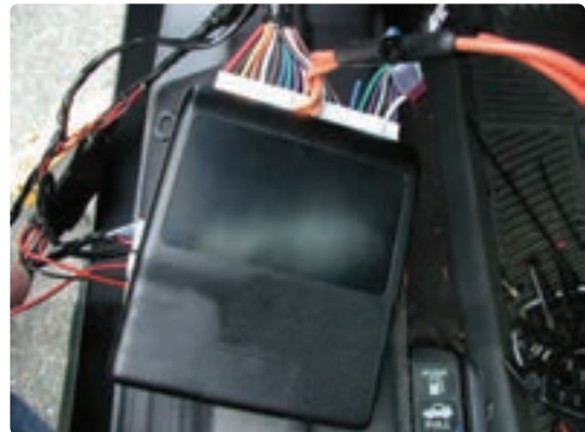
شکل ۱-۳- واحد اصلی سیستم دزدگیر
