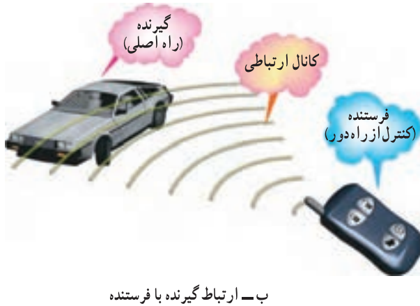
شکل ۳-۶- قطعات سیستم دزدگیر و دزدگیر به عنوان یک سیستم مخابراتی
