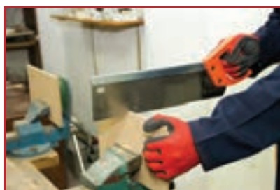
الف- بریدن قطعات با اره ظریف بر
