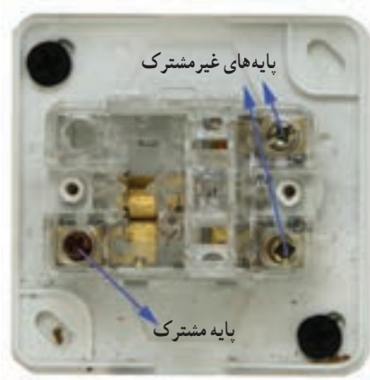
شکل ۱۹-۵- نمای داخلی یک نمونه کلید تبدیل
