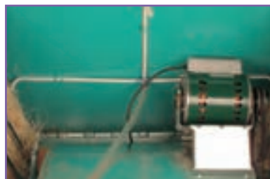
ح- آزمایش صحت مدار آب پخش کن
