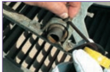
ث- روغن‌کاری یاتاقان‌ها
