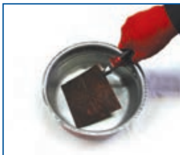
شکل ۹-۱- سرد کردن پلاک مسی با آب
