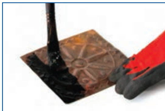
شکل ۱۰-۱- آغشته کردن سطح پلاک مسی به قیر
