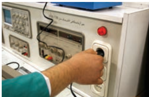
شکل ۱-۷- اتصال صحیح دو شاخه
