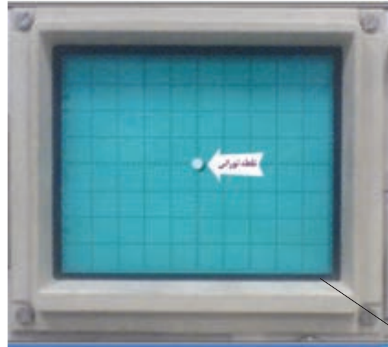
شکل ۵-۵ تولید نقطه نورانی به وسیله اشعه کاتدیک
