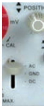
شکل ۱۶-۵- اتصال سیگنال AC به ورودی اسیلوسکوپ
