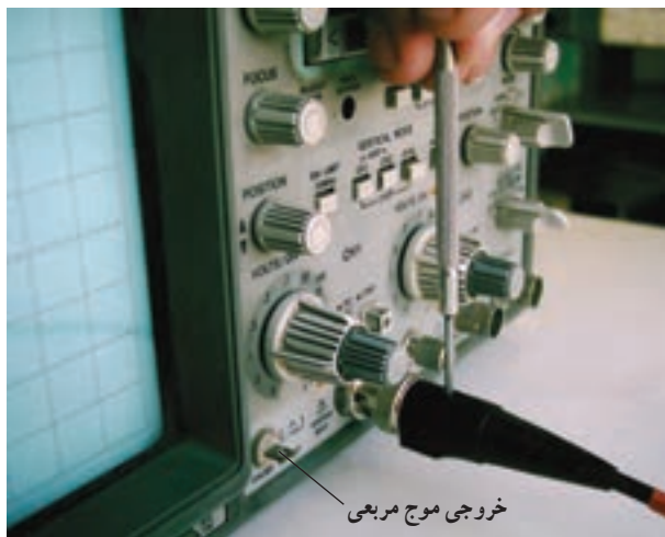
شکل ۵-۱۳ نحوه تنظیم پروب برای مشاهده موج مربعی
