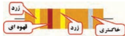
شکل ۲-۷- دیود با نوارهای رنگی
