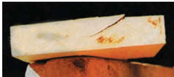
شکل ۳۵-۱- ورقه شدن چوب به وضوح دیده می‌شود.
