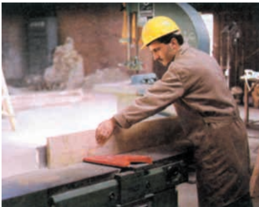
شکل ۷۵-۱- رنده کردن ضخامت (تر) تخته با رنده‌ی برقی
