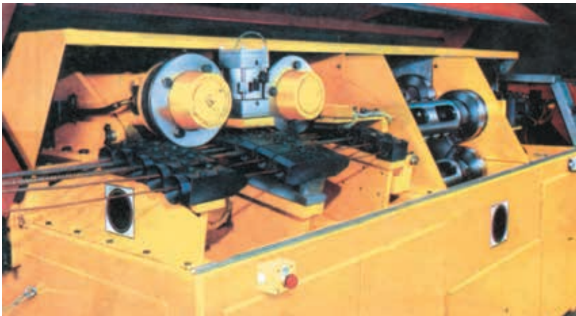
شکل ۵۲-۲- دستگاه کشش برقی برای صاف کردن میل‌گرد
