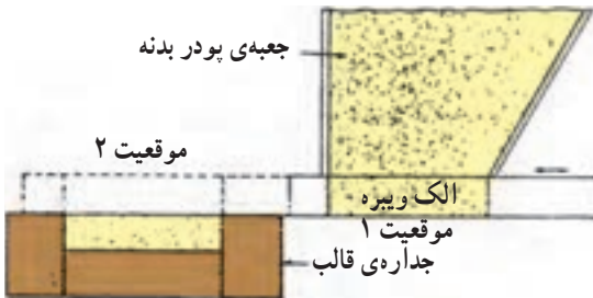
شکل ۸-۴- سیستم اتوماتیک پرکننده‌ی قالب کاشی
