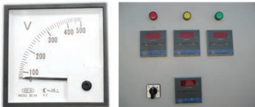
شکل ۹-۱۱- نمونه ولت متر تابلویی
