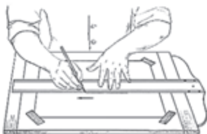
شکل ۱-۱۲- نحوه‌ی استفاده از خط کش T و گونیا
