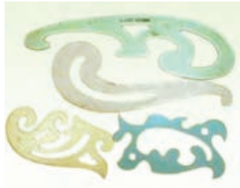
شکل ۱۹-۱- نمونه‌هایی از منحنی‌کش یا پیستوله
