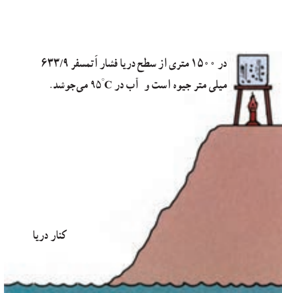
شکل ۱۰-۲- آب در فشار 633/9 میلی متر جیوه در دمای 95^{\circ}\text{C} می جوشد.
