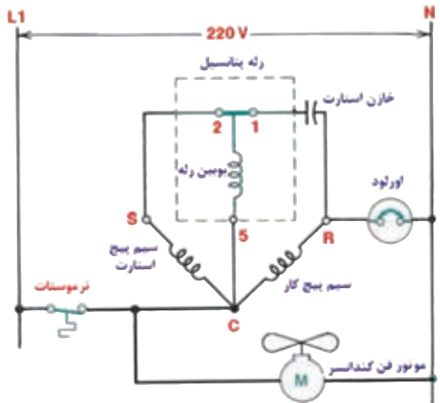
شکل ۸-۱- مدار الکتریکی آب سردکن
