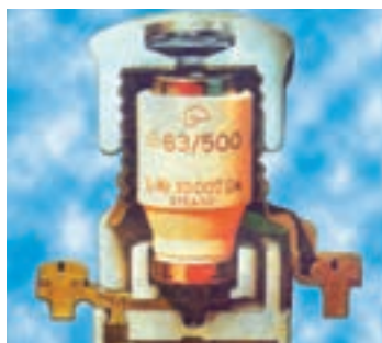
(ج) نمای برش‌خورده شکل ۲-۴ فیوز فشنگی.
