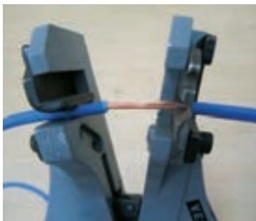
شکل ۳-۸ مراحل لخت کردن سیم توسط سیم‌لخت‌کن اتوماتیک.
