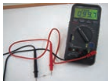
شکل ۱-۲۱ نحوه اندازه گیری مقاومت با اهم متر.
