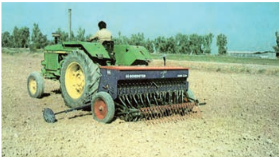
شکل ۱-۲- بذرکار خطی‌کار در حال کاشت گندم
